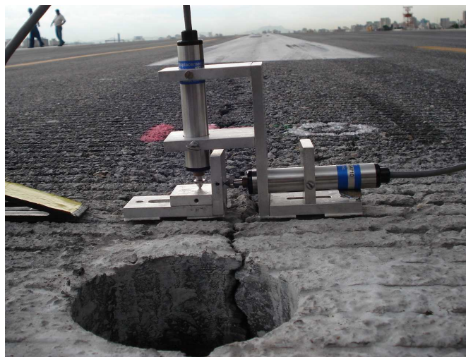
Figura 3: Medidor de desplazamiento “Crack Activity Meter” instalado en la pista.
