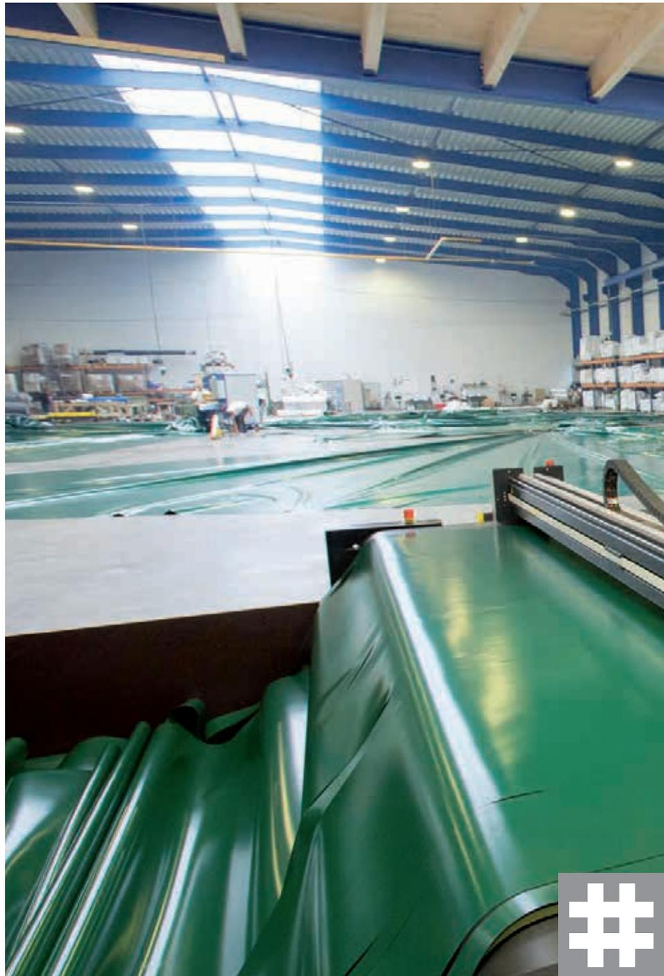
Taglio su misura delle membrane tramite macchine a controllo numerico
