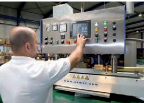
Saldatura ad alta frequenza delle membrane
