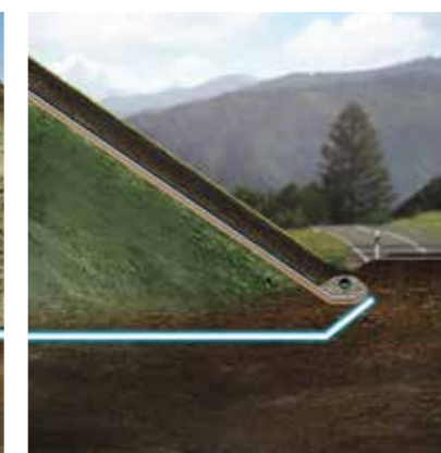
Costruzione con terreni contaminati
