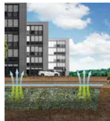
Capping attivo di terreni contaminati
