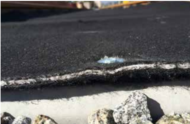
Dettaglio del Tektoseal Active AS; strati superiore e inferiore costituiti da geotessile non tessuto in PP e strato attivo polimerico nel mezzo
