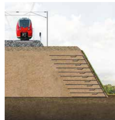
Muri di sostegno/terre rinforzate
