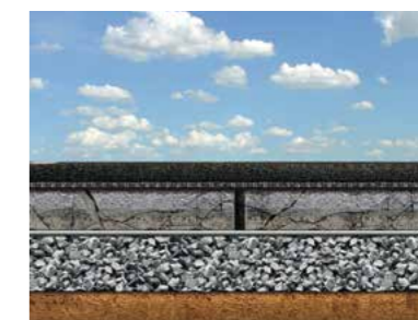
Risanamento di Pavimentazioni in Calcestruzzo con Pavimentazioni Bituminose
