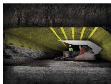
Rinforzo di pareti di scavo, volte e pilastri
