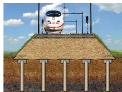
Rilevati su Pali
