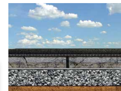
Risanamento di Pavimentazioni in Calcestruzzo con Pavimentazioni Bituminose
