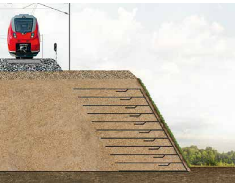
Opere di sostegno/scarpate ripide
