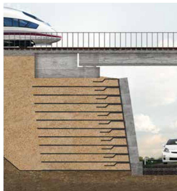
Spalle di ponti
