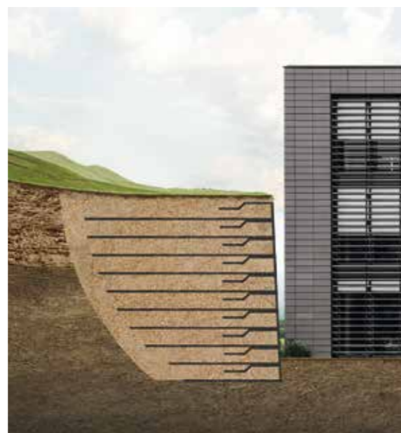
Contenimento della pressione laterale del terreno
